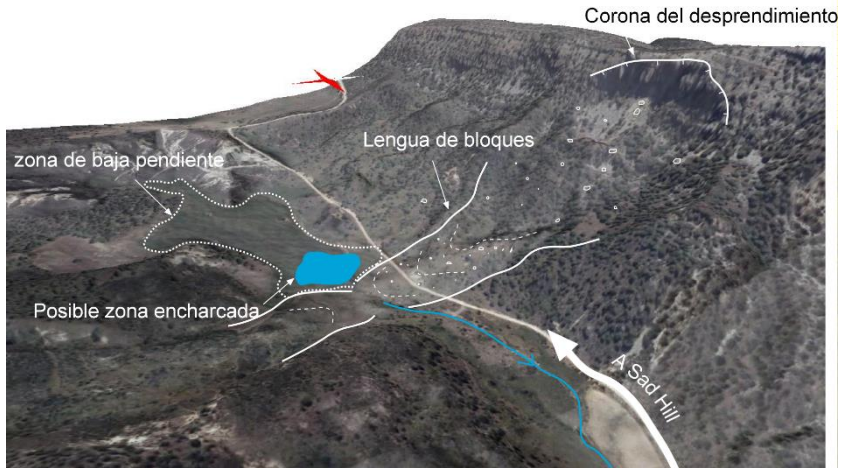
Figura 8: Desprendimiento de rocas que provoca un tapón del valle haciendo que la zona aguas arriba quede encharcada.
